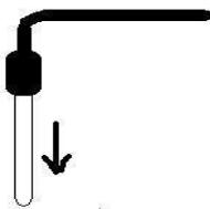
**IT** Inserire la sonda di Rx nella soluzione tampone a 468mV. Attendere qualche secondo la stabilizzazione della lettura.
