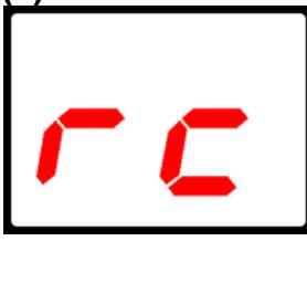
**IT** Se alla fine della calibrazione il display mostrerà la scritta "rc", premere il tasto CAL per uscire dalla calibrazione e tornare in lettura. Ripetere la procedura di calibrazione e se dopo il secondo tentativo comparirà ancora la scritta "rc", cambiare la sonda che non è in buona salute e va sostituita.
