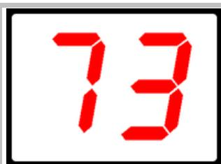
**IT** Il regolatore REG.SPEEDY 1-RX visualizza sul display il valore dei mV letti dall'elettrodo ed attiva la presa a 230V, 50Hz se la misura è inferiore al setpoint desiderato dal cliente. Il funzionamento del Regolatore è di tipo ON-OFF cioè con misura inferiore al Setpoint la presa è alimentata a 230V, 50Hz e con misura superiore al setpoint la presa non è alimentata.
